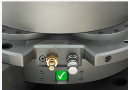
Die grüne Anzeige zeigt, dass richtig gespannt ist.
