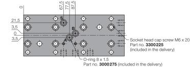
45,5 39 ±0,02 59 ±0,02 59 ±0,02 9 23,5 23,5 39 M6 x 8 deep (8x) **A** = Clamping 14 + 0.0212 ±0,02 12 ±0,02 **B** = Unclamping 12 ±0,02 12 ±0,02 **S** = Central lubrication Φ Φ 14 ±0,02 14,5  $50,5\pm0,02$ 50,5 ±0,02 Ø10 H7x7 deep (4x)
