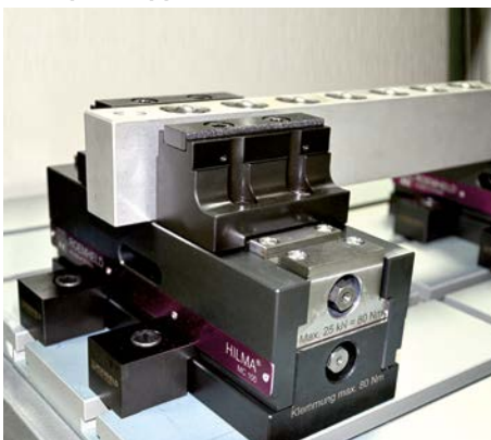
Serrage des tasseaux en aluminium HILMA.MCP 100 Z Balance.
