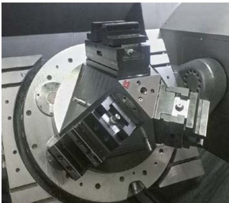
3 systèmes de serrage HILMA.MCP disposés en 3 x 120° sur un centre d'usinage 5 axes.
