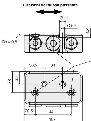
Per il montaggio a flangia rimuovere le viti a testa cilindrica e gli anelli di tenuta. Avvitare due tappi filettati G1/4 (No. Ordin. 3610006). (Non compreso nella fornitura)
