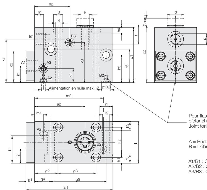
Pour flasquer le vérin, enlever les vis cylindriques et les rondelles d'étanchéité en USIT et monter 2 vis de fermeture G1/4.
