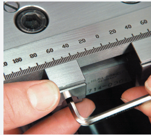
2. Impostare i bordi esterni degli inserti circa 2 mm al di sotto della misura finita.
