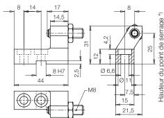
Mâchoire pour le bridage extérieur d'une nervure de pièce avec une épaisseur de 6 à 14 mm (réglable de 0 à 18 mm).
