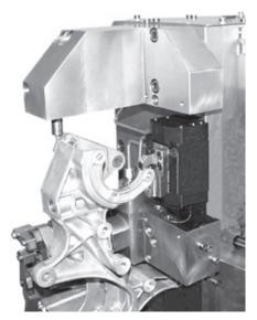
La figure montre un bloc de serrage flottant pour le bridage «flottant» d'un bras isolé d'un support pour sous ensemble du secteur automobile, lequel a été fixé dans sa position par des vérins de serrage pivotant selon page B 1.880 et B 1.891.
