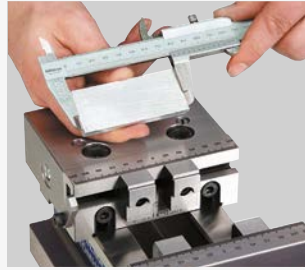
1. Rohling liegt ca. 2mm über dem Fertigmaß.
