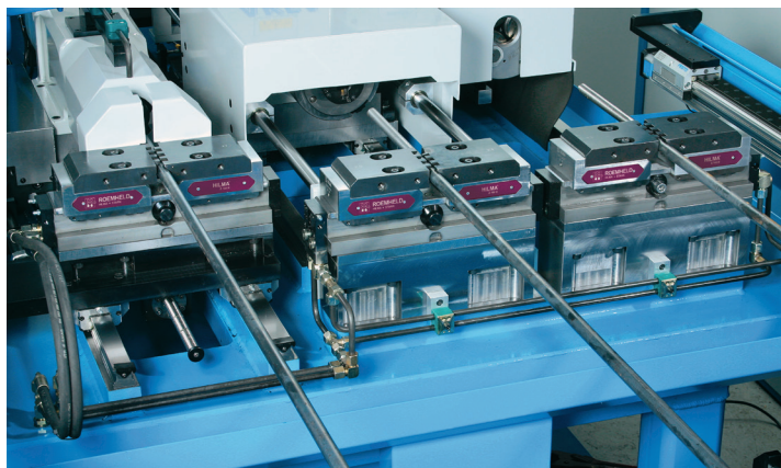
Étaux de serrage ZH en service
