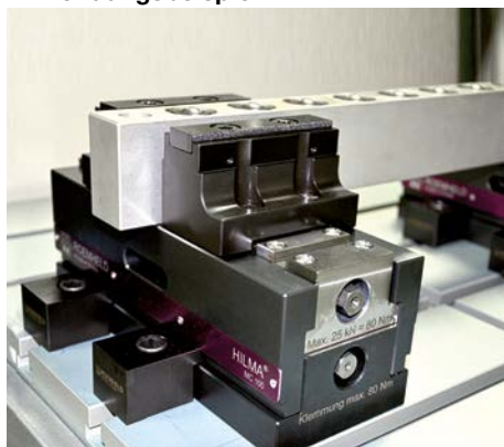
Spannen von Aluminiumleisten mit Spannsystem HILMA.MCP 100 Z Balance.
