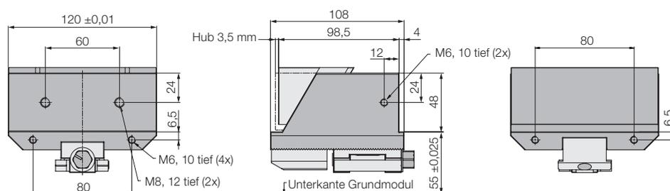
**Niederzug-Spannmodule** inkl. Spannbacke
