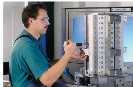
3. Fixieren des Spannmoduls über Exzenter-schraube mit Drehmomentschlüssel.
