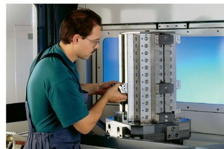
2. Einrichten an der gewünschten Position des Grundmoduls mit Hilfe der Referenzmarkierung und des Maßstabs.
