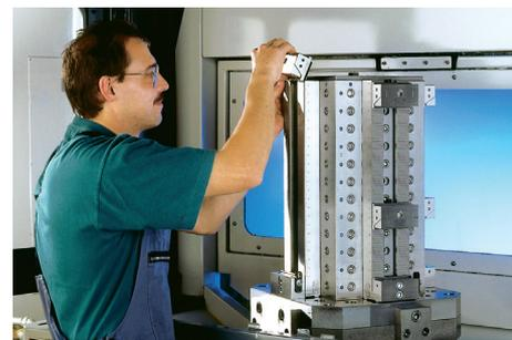
1. Das Spannmodul wird mit gelöster Exzenterklammer in die Nute eingefahren.
