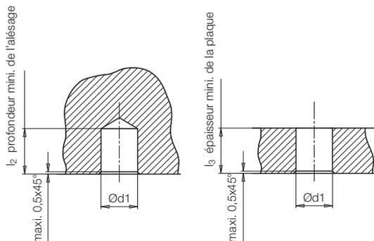
Ø de réglage de la douille de serrage :  $k = d1 - 0,2 \text{ mm}$
