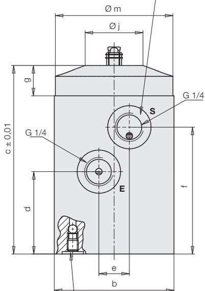
Pour flasquer enlever le boulon fileté avec bille et insérer le joint torique dans le lamage (voir accessoires)
