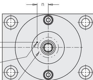
Ø d'appui minimale de la pièce à usiner:
