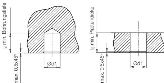
Einstell-Ø der Spannbuchse:  $k = d1 - 0,2 \text{ mm}$
