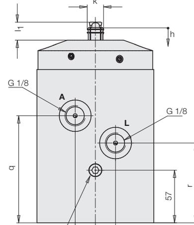
Entlüftungsschraube nur bei Baugröße 4318211X
