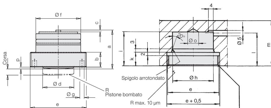
Dopo il montaggio del cilindretto assicurare la filettatura con grano filettato AM 4x4 DIN 913
