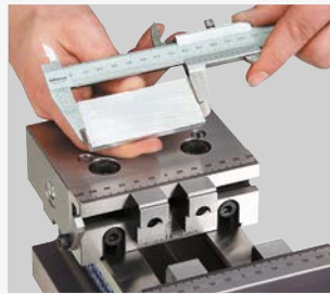
1. L'ébauche est env. 2 mm au-dessus de la dimension finie.
