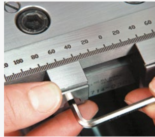
2. Ustaw zewnętrzne krawędzie wkładek ok. 2 mm poniżej rozmiaru na gotowo.
