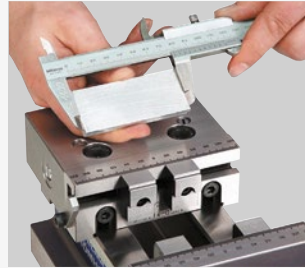
1. Półfabrykat posiada ok. 2mm naddatku na obróbkę
