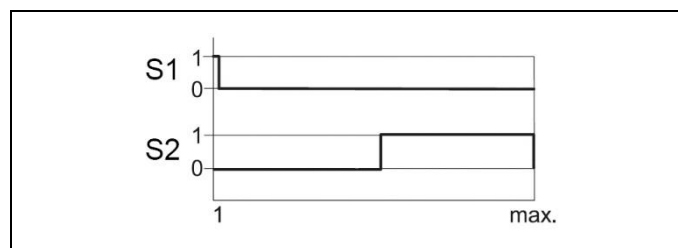
Fig. 9: Courbe du signal pendant le procédé de bridage
