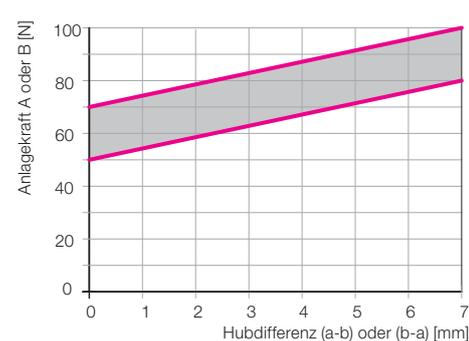
Diagramm gültig für waagerechte Einbaulage. Bei senkrechter Anordnung ist die Masse der Spannbacken zu berücksichtigen.
