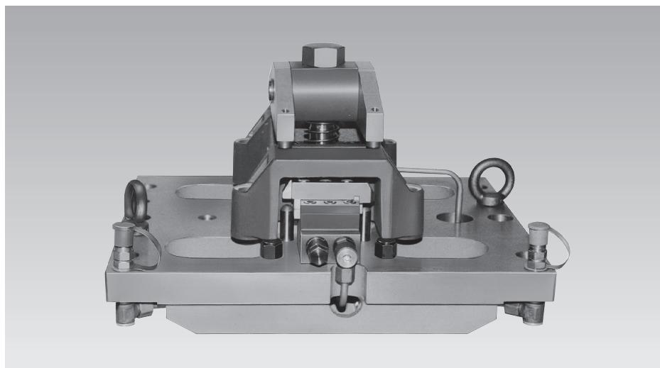
Die nebenstehende Abbildung zeigt eine hydraulisch betätigte Vorrichtung zum zentralen Positionieren und Spannen von zwei gegossenen Gehäusen, bei denen die Innenflächen aus Funktionsgründen genau mittig zu den zu bearbeitenden Bohrungen liegen. Durch den Einsatz von Zentrisch-Spannelementen konnte die Bearbeitung der Innenflächen vermieden werden.
