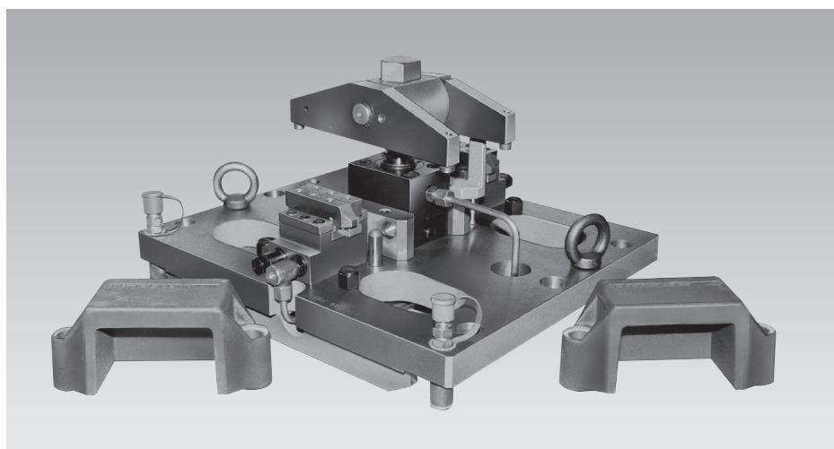
Die Spannvorrichtung in Plattenbauweise wird auf einem Vertikal-BAZ mit Wendeeinrichtung und Gegenlager eingesetzt.
