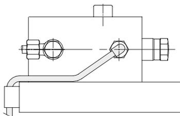
Der Anschluss eines Belüftungsschlauchs ist dann sinnvoll, wenn die Öffnung an eine Stelle verlegt wird, wo garantiert keine Flüssigkeit eindringen kann.
