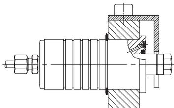
Spannelemente ohne Belüftungsanschlussmöglichkeiten können abgedeckt werden, was aber angesichts der heute üblichen Kühlmittelmengen keinen Erfolg verspricht. Man sollte dann auf diese Spannelemente ganz verzichten und vorzugsweise doppelt wirkende Elemente einsetzen.
