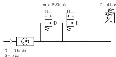
Zur Auswertung des pneumatischen Druckaufbaus können handelsübliche Pneumatik-Druckschalter verwendet werden. Es ist möglich mit einem Druckschalter bis zu 8 parallel geschaltete Positionskontrollen abzufragen (siehe Schaltplan).
