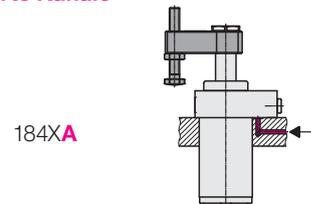
**Pneumatische Positionskontrolle integriert**
