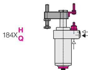
**Elektrische Positionskontrolle in Spann- und Entspannstellung**
