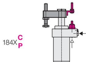
**Positionskontrolle als Zubehör Schaltstange für externe Sensoren**
