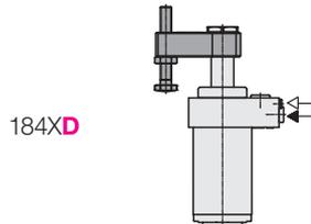
**Pneumatische Positionskontrolle in Spann- und Entspannstellung**
