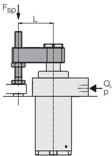
In der Tabelle auf Seite 3 sind die zulässigen Volumenströme zum Spannen und Entspannen mit den Zubehör-Spanneisen angegeben. Längere Sonderspanneisen haben ein größeres Trägheitsmoment. Damit die Schwenkmechanik nicht überlastet wird, muss der Volumenstrom reduziert werden.
