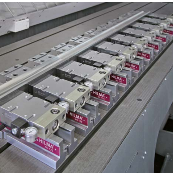
HILMA.NC mit Spannkraftanzeige
