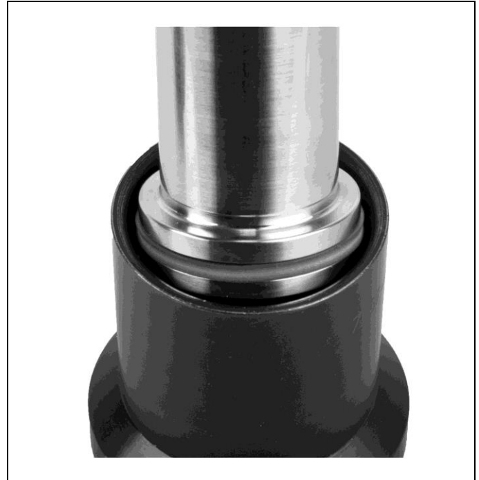
Abb. 8: Kalibrierung einer Außendichtung mit Werkzeug
