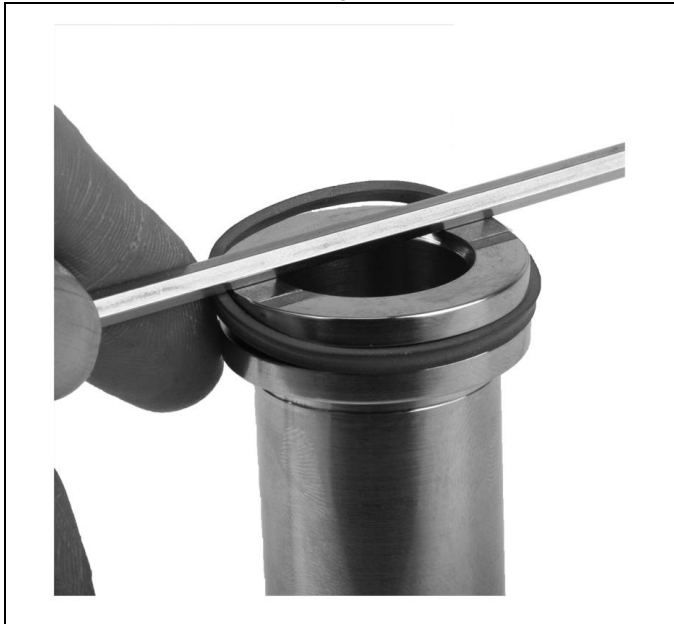
Abb. 7: Einbau in einer geschlossenen Nut, ohne Hilfsmittel
