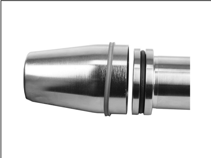
Abb. 9: Einbau in einer geschlossenen Nut, mit Sprezhülse
