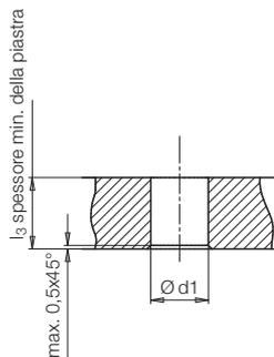
**Ø di regolazione della bussola di bloccaggio: k = d1 - 0,2 mm**
