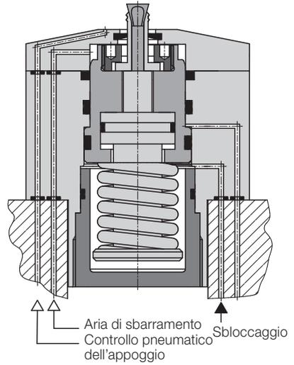
**Bussola di bloccaggio solo espansione**
