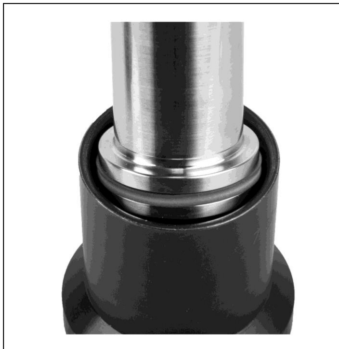
Fig. 8: Calibratura di una guarnizione esterna con attrezzo
