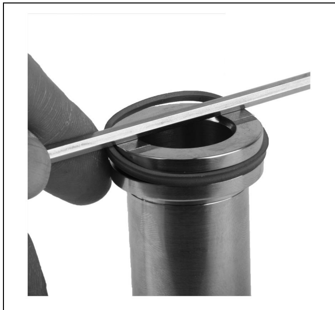
Fig. 7: Montaggio in una cava chiusa senza mezzi ausiliari
