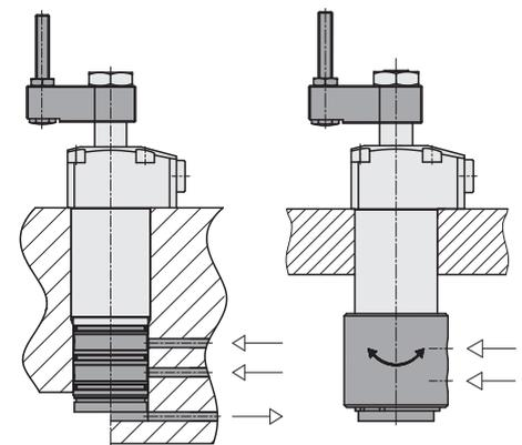
Ejecución insertable      Conexión a rosca para tubos
