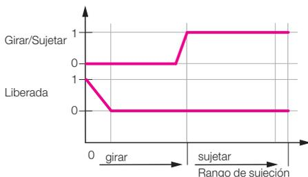
**Consulta mediante por presostato neumático**
