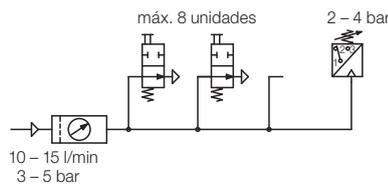
Para evaluar el aumento de presión neumática pueden utilizarse presostatos neumáticos convencionales. Con un presostato es posible consultar hasta 8 controles de posición.
