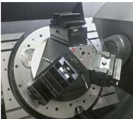
3 Werkstück-Spannsysteme HILMA.MCP in 3x120°-Anordnung auf einem 5-Achs-Bearbeitungszentrum.
