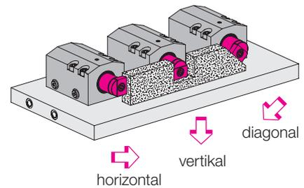
Die Spannrichtung kann wahlweise in alle Richtungen senkrecht zur Spannhelbelachse erfolgen. Dazu ist der Spannhelbel in eingefahrener Stellung und der Zylinderdeckel um den entsprechenden Winkel zu verdrehen. Beim Einstellen der Spannrichtung am Deckel ist darauf zu achten, dass die Spannrichtung des Druckstücks in die gleiche Richtung zeigt.
