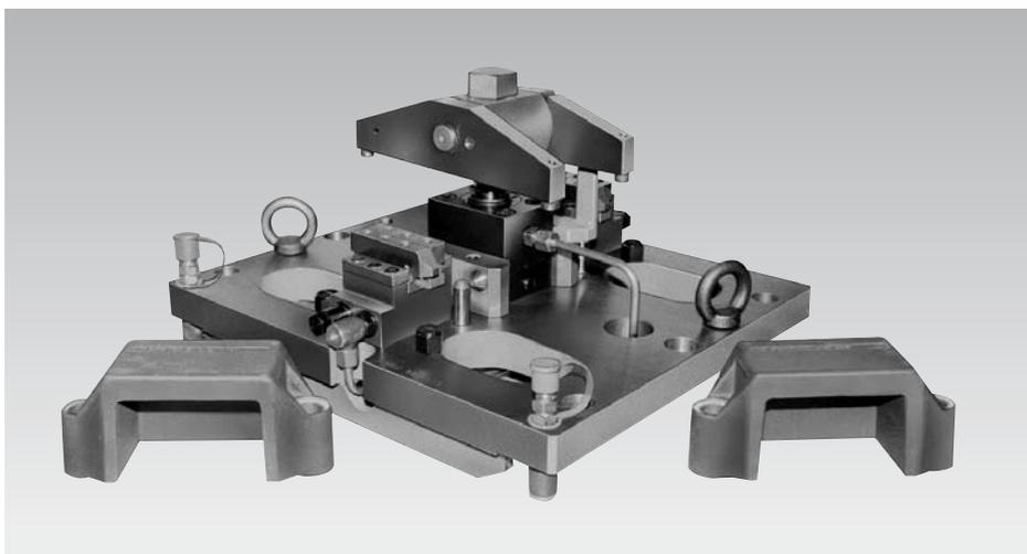
Questa attrezzatura di bloccaggio su piastra viene impiegata su un centro di lavorazione verticale con staffe di bloccaggio rotanti e controsupporto.
