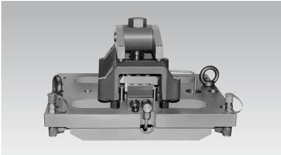
L'illustrazione qui a lato riporta una attrezzatura ad azionamento idraulico per il posizionamento centrato ed il bloccaggio di due scatole prodotte mediante fusione, le cui superfici interne devono risultare, per ragioni funzionali, esattamente centrate rispetto ai fori da lavorare. Grazie all'impiego degli elementi di bloccaggio in posizione centrata è stato possibile evitare la lavorazione delle superfici interne.
