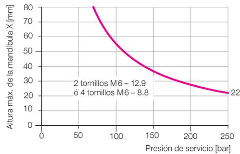
**Altura máx. de las mandíbulas X para 4413151 en función de la presión de servicio**
