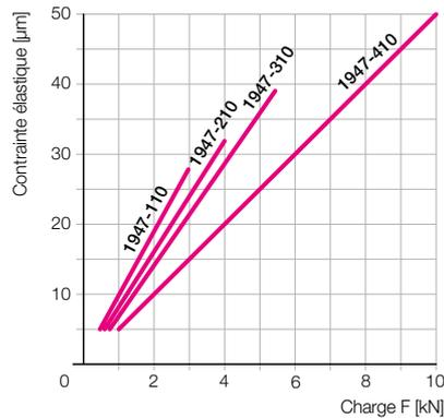
**Force de contact du ressort F<sub>F</sub> en fonction de la course du piston d'appui h**
