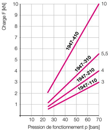
**Contrainte élastique sous charge F et pression de fonctionnement 70 bars**
