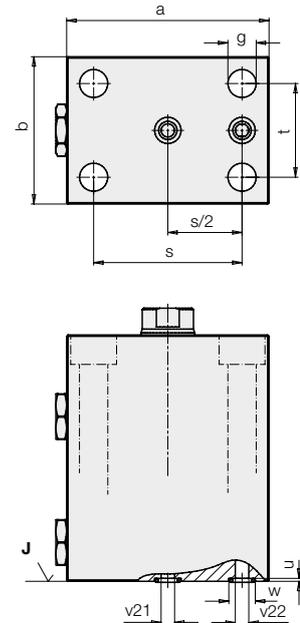
\*Zum Einsatz des Sensors auf der linken Seite, wird der Zylinder um 180° gedreht und die Verschlußschraube mit Dichtring und O-Ring zum Aufflanschen gegeneinander getauscht.
