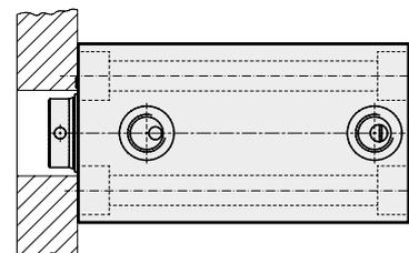
Bei Betriebsdruck über 100 bar müssen die Zylinder hinten abgestützt werden
