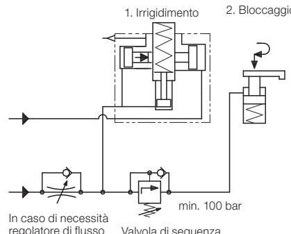
La valvola di sequenza deve essere impostata ad una pressione di apertura al di sopra del punto di intersezione fra le due rette nel diagramma.
