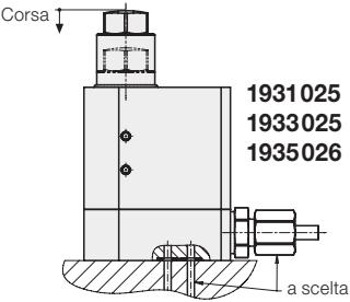
Al caricamento dell'attrezzatura il perno d'appoggio viene fatto arretrare dal pezzo e vi aderisce per effetto della molla. Può essere poi eseguito il bloccaggio idraulico. Allo sbloccaggio, il perno d'appoggio viene allentato e poi spinto in fuori dalla molla quando viene estratto il pezzo.
