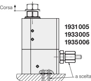
All'immissione dell'olio in pressione, il perno d'appoggio fuoriesce e si accosta al pezzo con la forza della molla. Successivamente il serraggio avviene in modo automatico
