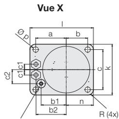
Vis d'évent ou raccordement pour l'air de soufflage
