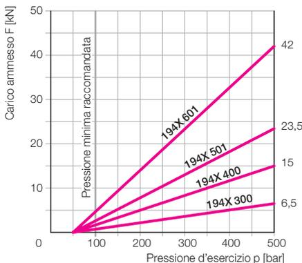
**Modifica delle lunghezze elastiche con forza di carico F e pressione d'esercizio 500 bar**
