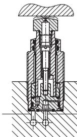
Estendere perno irrigiditore + Controllo dell'appoggio (aria di sbarramento) Perno di appoggio Irrigidimento
