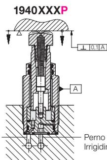
Controllo dell'appoggio (aria di sbarramento) Perno di appoggio Irrigidimento
