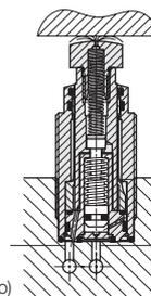
Controllo dell'appoggio (aria di sbarramento) Estendere perno irrigiditore + irrigidimento
