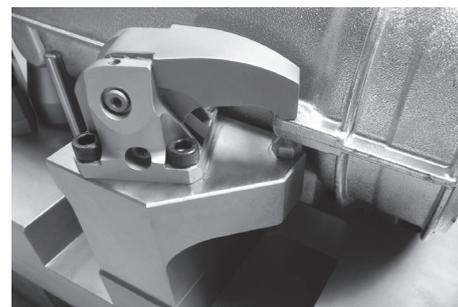
Bloccaggio di una fusione in ghisa
