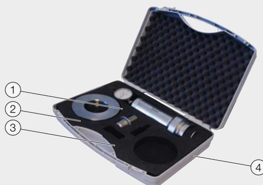
Testeur de la force de traction (1) avec certificat de calibrage et manuel d'utilisation dans la boîte en plastique, avec bague d'appui (2), adaptateur de pion de serrage (3) et rondelle d'écartement (4)
