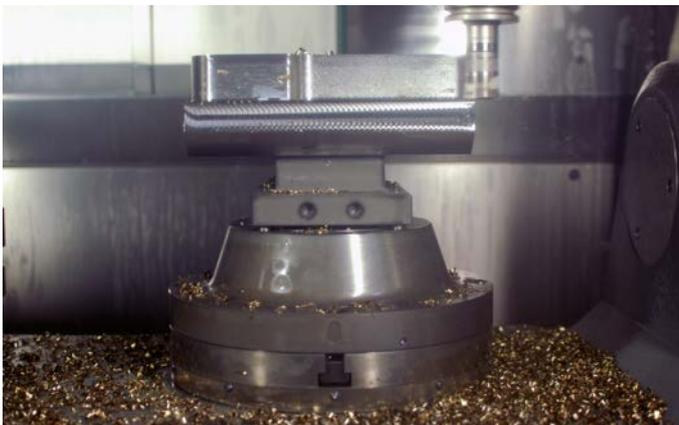
Rigidité extrêmement élevée grâce à un ajustement sans jeu et à une force de précontrainte élevée des rondelles-ressorts (éléments à desserrage hydraulique) ou des ressorts fils (éléments à desserrage pneumatique).
