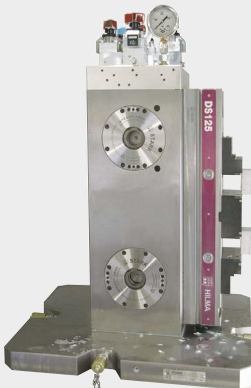
Modules de serrage rapide STARK.classic.2 avec coupleurs montés de chaque côté de la tour de serrage. Le déclenchement des étaux de machines HILMA s'effectue par le biais des valves de commande placées en haut.
