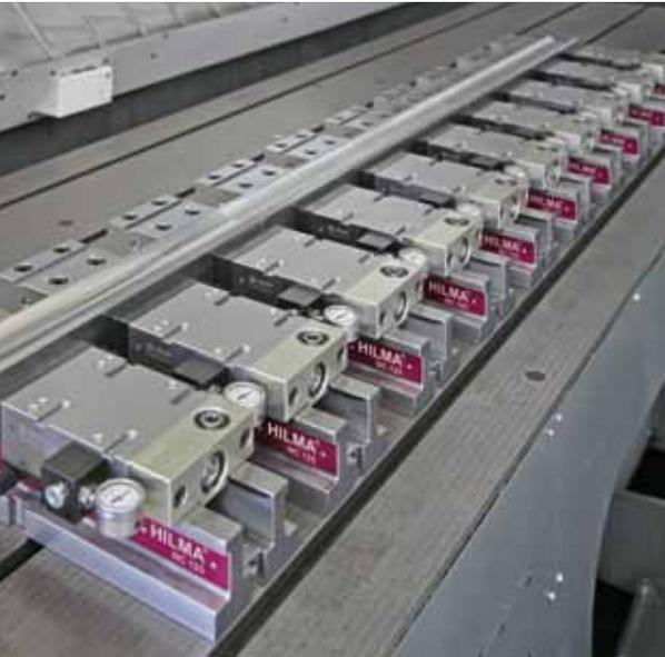
DS idraulica con ganasce flottanti
