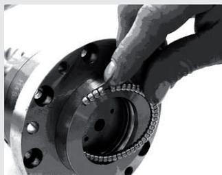
2) Den Kugelring vor dem Einbau leicht einfetten. Austauschkelring mit dem unteren Ende in der Rille ansetzen.
