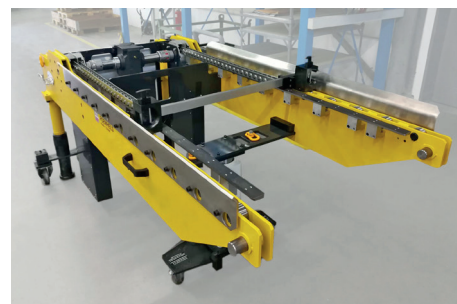
Vista su catena push-pull e adattatore stampo
