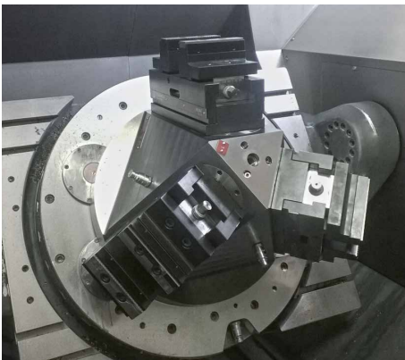
3 étaux de serrage MC-P disposés en 3 x 120° sur un centre d'usinage 5 axes
