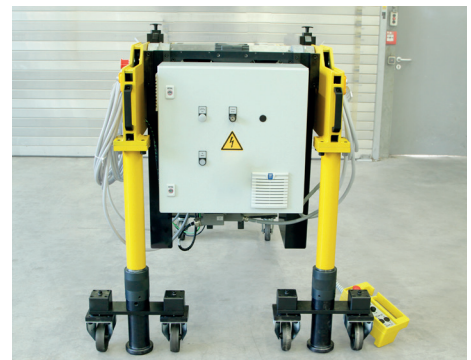
Optional: Die Steuerung ist direkt an der Konsole angebracht, Konsole und Steuerung können vollständig entfernt werden.
