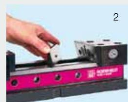
I magneti permanenti ed il perno di guida mantengono l'inserto ganascia nella sua posizione base.
