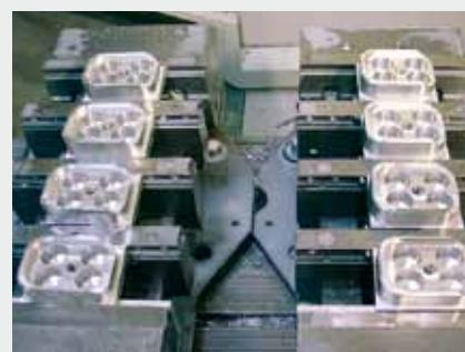
Il bordo di bloccaggio viene fresato nella 2a fase di serraggio.
