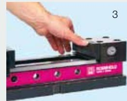
Per cambiare l'inserto ganascia, tirarlo verso l'alto finché il perno di guida si impegni nella cava.
