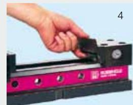
Inclinare leggermente l'inserto ganascia per superare la forza di tenuta dei magneti permanenti.
