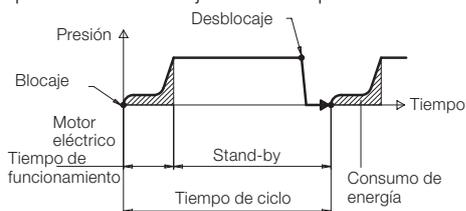
En este ejemplo de un útil de sujeción hidráulico el tiempo de funcionamiento del motor eléctrico corresponde al tiempo de sujeción, es decir sólo algunos segundos.
