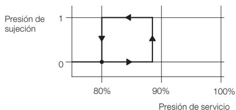
El punto de conexión debe ser regulado a 80% de la presión de sujeción prevista.
