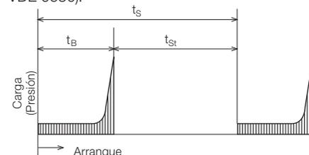
$t_B$  = Tiempo de carga del motor eléctrico desde el arranque hasta la desconexión (tiempo de sujeción)
