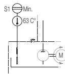
El control de la temperatura y del nivel de aceite está instalado en la tapa del depósito y eléctricamente conectado con el armario eléctrico. En el caso de un mensaje de error, el diodo luminoso de control por debajo del interruptor general se enciende.
