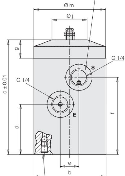
Zum Aufflanschen Stiftschraube mit Kugel entfernen und O-Ring in Senkung einlegen (siehe Zubehör)
