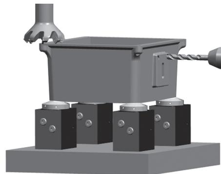
Bei Anschluss Druckölzuführung über gebohrte Kanäle müssen die Anschlussgewinde mit einer Verschlusschraube verschlossen werden (siehe Zubehör)
