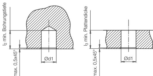
**Einstell-Ø der Spannbuchse: k = d1 - 0,2 mm**
