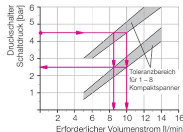
Erforderlicher Volumenstrom abhängig vom Schaltdruck des pneumatischen Druckschalters für einen Druckabfall  $\Delta p$  2 bar
