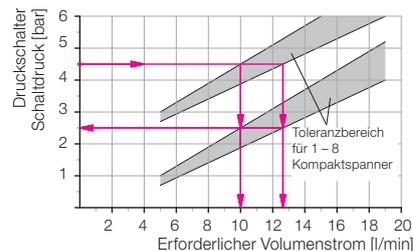
Erforderlicher Volumenstrom abhängig vom Schaltdruck des pneumatischen Druckschalters für einen Druckabfall  $\Delta p$  2 bar
