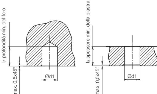
Ø di regolazione della bussola di bloccaggio:  $k = d1 - 0,2 \text{ mm}$
