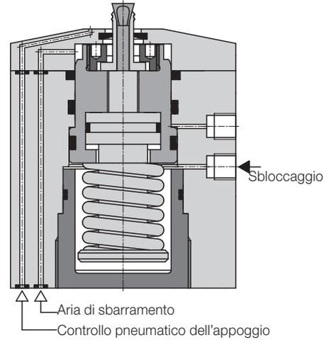
**Bussola di bloccaggio solo espansione**
