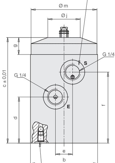
Per il montaggio a flangia rimuovere il grano di fissaggio con la sfera e introdurre l'O-Ring nella sede (vedere Accessori)
