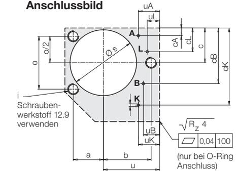
Anschlüsse A, B, K, L: max.  $\varnothing 6$  mm
