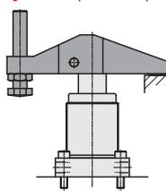
La brida de sujeción asimétrica se basa en el apoyo fijo.
