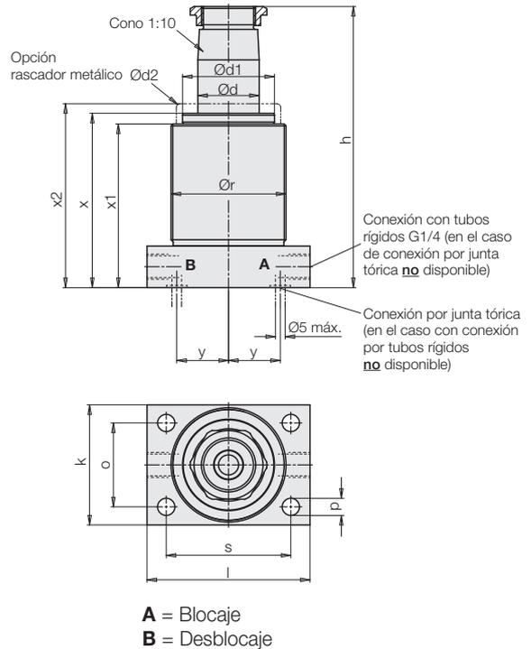
Esquema de conexión por junta tórica
