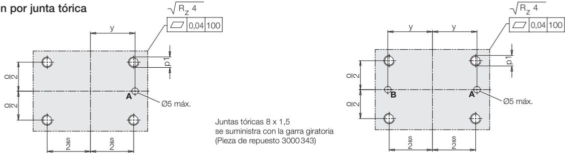
Ejecución roscada con conexión por tubos rígidos G 1/4
