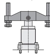
La brida simétrica de sujeción doble puede bloquear al mismo tiempo dos piezas a mecanizar, la fuerza de tracción del pistón se divide en dos. Los muelles instalados garantizan una posición inicial horizontal.
