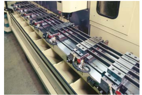
HILMA.DS hydraulisch betätigt, Einsatz in Reihen-anordnung zum Spannen von Werkstücken, die mehrere Spannstellen erfordern. Automatisierbar.
